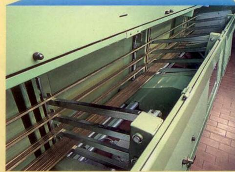
Il mod. TS 560 P è dotato di un magazzino a 3/4 piani sovrapposti eletticabili (brevetto IEMCA) con una capacità massima totale di 1800 mm, pari a 70 barre di Ø 25 mm.
