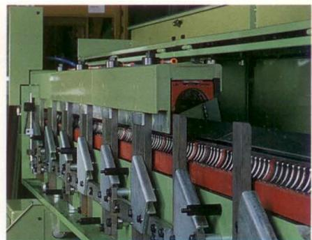
Un impianto di circolazione d'olio immette l'olio all'interno delle guide elastiche riducendo al minimo le vibrazioni della barra. Il circuito dell'olio è chiuso ed a recupero totale.
