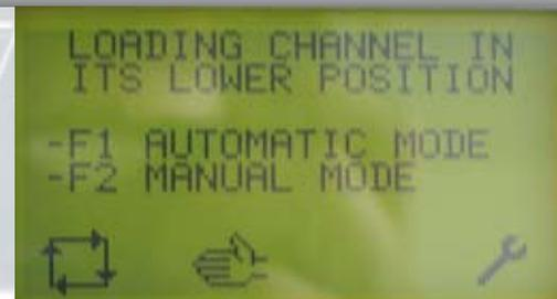
Un comando intuitivo comprendente una auto-diagnostica permette all'operatore la gestione semplice e intuitiva del caricatore. Se necessario, il supporto tecnico internazionale della LNS darà una pronta soluzione a tutti i problemi mediante l'accesso diretto a interlocutori qualificati.
